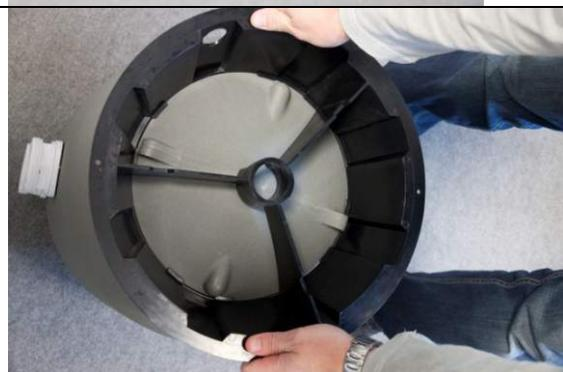
Stellen Sie den Filterkessel nun auf seinen Sockel und legen die 2 kleinen O-Ringe in die Aussparung der vormontierten Anschlussstücke des Rückspülventils
